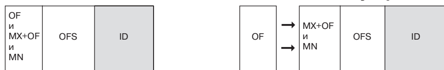
OF Блок-контакт состояния MX Независимый расцепитель MN Расцепитель минимального напряжения OFS Блок-контакт ID Дифференциальный выключатель нагрузки
